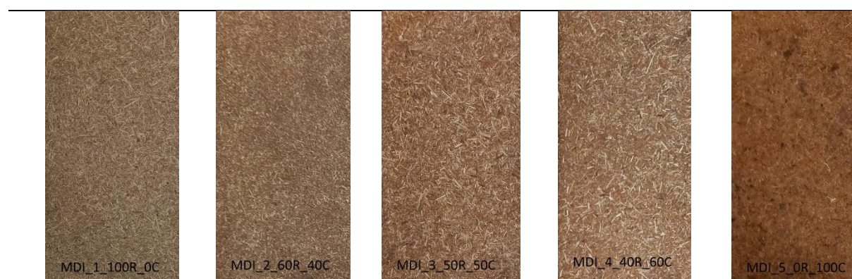
44. ábra. Kókusz és nád rostból MDI-vel (MDI1–MDI5) előállított kompozit panelek fényképei (forrás: szerző)
