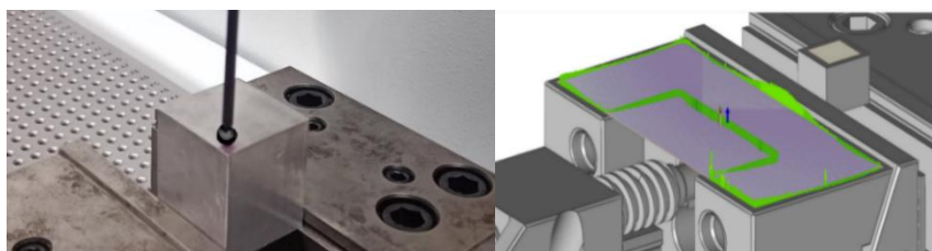
24. ábra CMM mérés beállítása és szkennelés a CMM beépített Touch DMIS rendszerben
