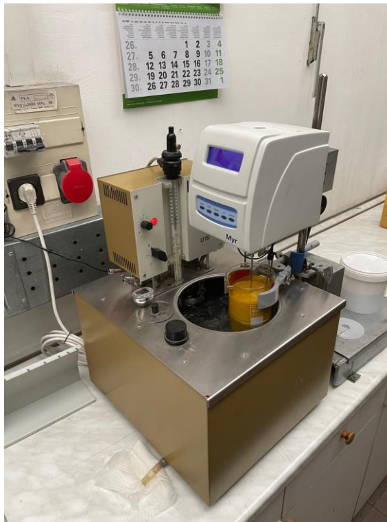
47. ábra: Rotációs viszkozimétert kombinálása egy temperáló berendezéssel
