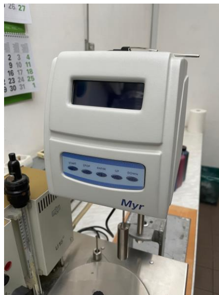
23. ábra: MYR V1-es típusú rotációs viszkoziméter
