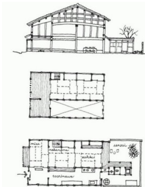
3.1.13. ábra Egy „kiomacsija” hosszmetsete és alaprajzi elrendezése
