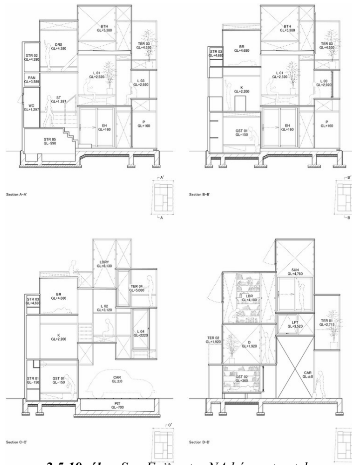
2.5.19. ábra Sou Fujimoto: NA ház metszetek
