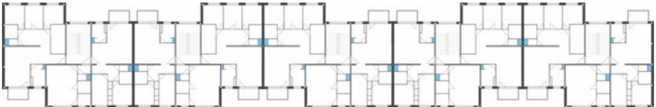
5.9. ábra A háztömb földémszint alaprajza a teherhordó falak és a gépészeti aknák feltüntetésével, Forrás: Palócz 2018
