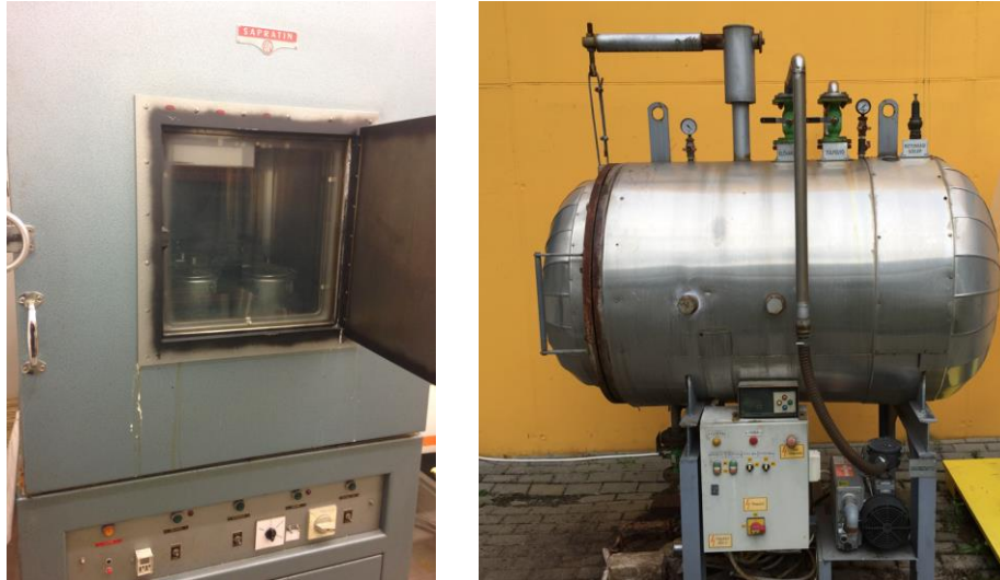
13. ábra: A nyomástartó edények 90, 100 és 110 °C -on a szárítószekrényben, 120°C -on nyomástartó hengerben voltak.
