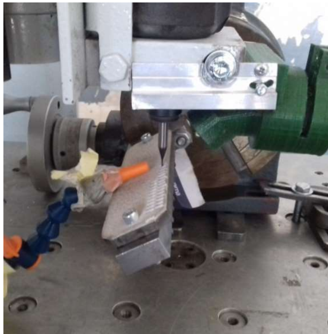
5.19. ábra: Munkadarab bedöntésre alkalmas készülék modell, és ebben a környezetben futtatandó szerszám pálya
