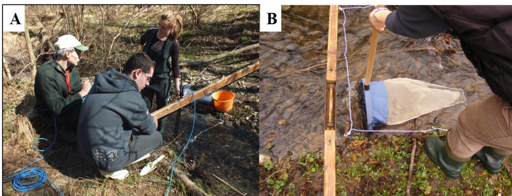
21. ábra Mintavétel (a) vízsebesség mérése ultrahangos sebességmérő műszerrel, (b) biológiai mintavétel
