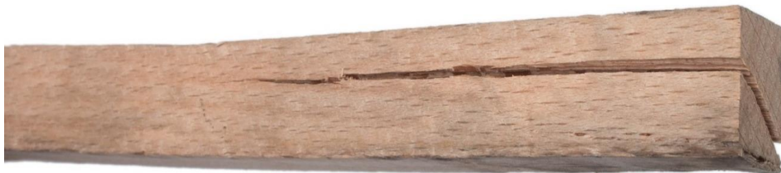
3.2. ábra Kezdeti hajszálrepedésből a tömörítés során keletkező nagyméretű bütürepedés (forrás: Báder és Németh 2017e)
