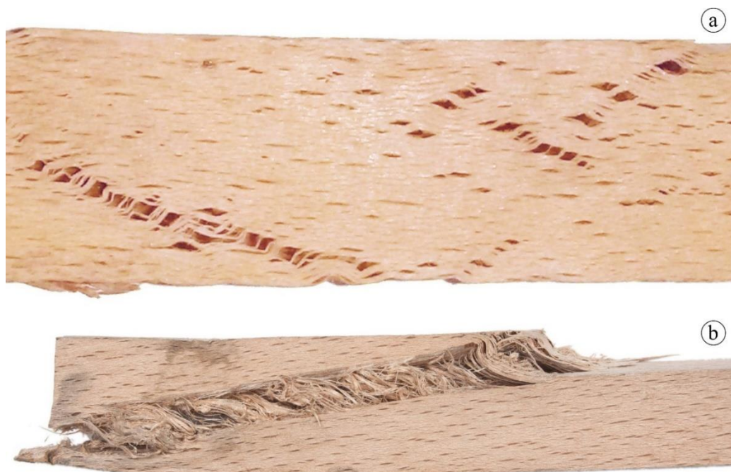
3.6. ábra Tömörítési hibák: rostelválások a bélsugarak mentén, majd ebből kiindulva az anyag megrogyása (a) és ferdeszalúság miatt ékként széthasadt minta (b) (forrás: Báder és Németh 2017a)
