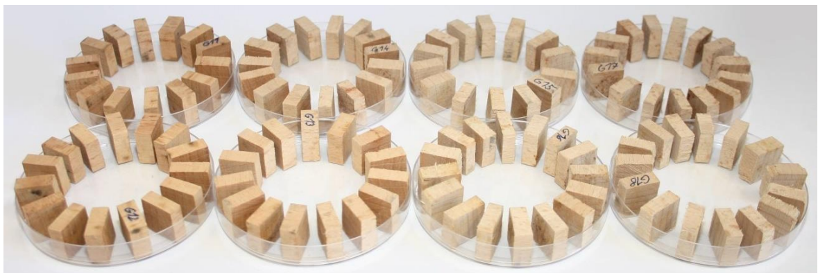
3.34. ábra Higroszkóposági vizsgálatok mintái csoportonként (forrás: Báder és Németh 2017b)
