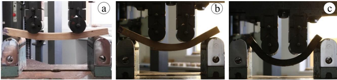
3.15. ábra Tipikus hajlítóvizsgálati minták az anyagvizsgáló gépben a tönkremenetel pillanatában: kezeletlen (a), rostirányban tömörített és 1 percet fixált (b), valamint tömörített és hosszú ideig fixált minta, mely nem törik el a hajlítóvizsgálat során (c)
