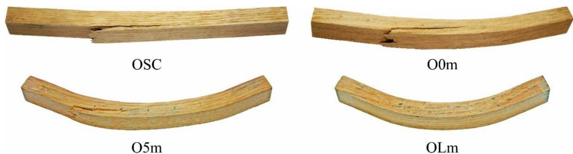
3.17. ábra A vizsgált famodifikálási eljárások jellemző törésképei (forrás: Báder és Németh 2018a). Rövidítések: OSC – gőzölt minta; O0m, O5m – rostirányban tömörített minták 0 és 5 perc fixálási idővel; OLm – tömörített és hosszú időn keresztül fixált minta
