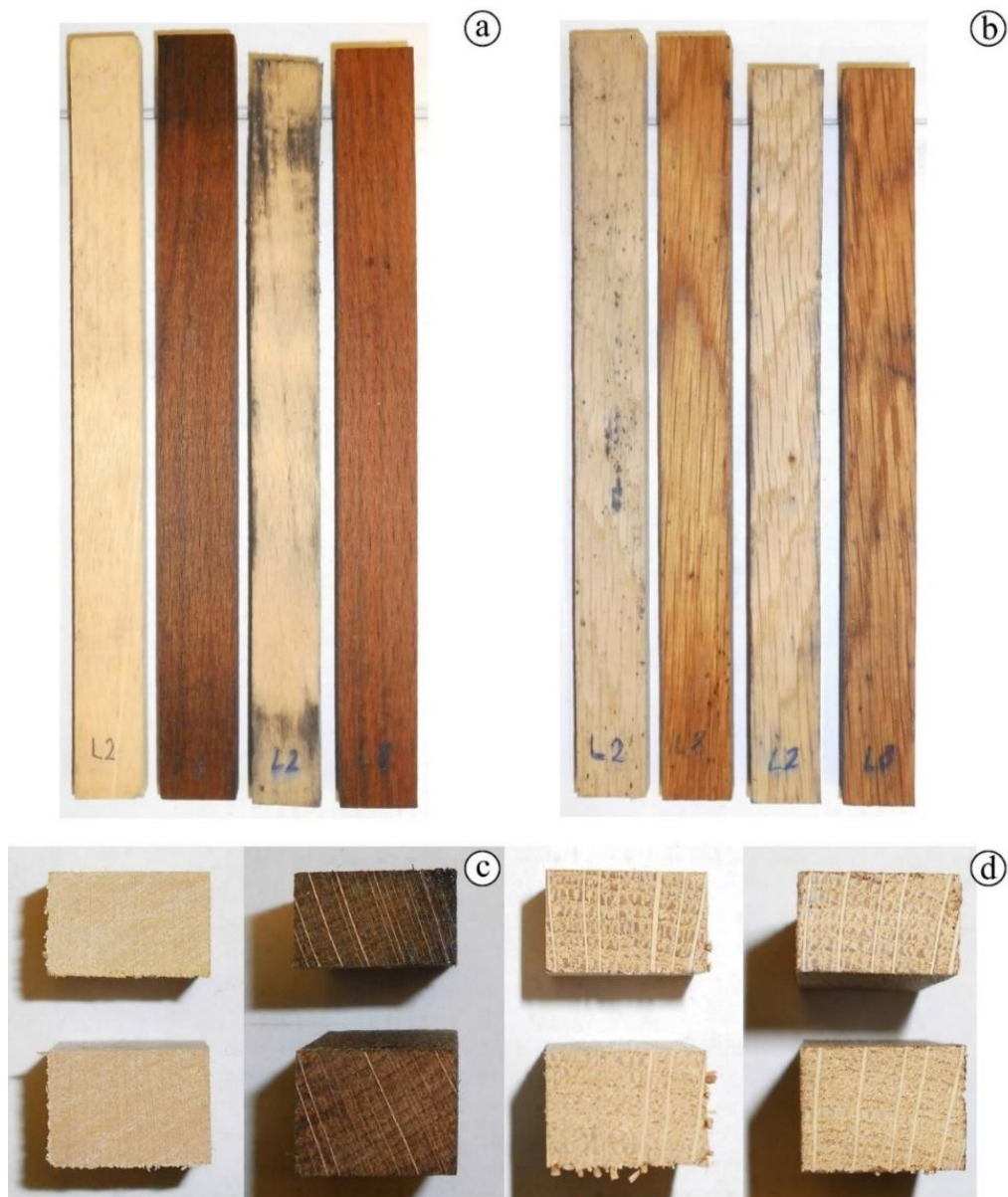
3.53. ábra Natúr (világos színű) és tejsavval kezelt (sötét színű) bükk (a) és tölgy (b) minták. Először a tömörítetlen párok, majd a tömörítettek, valamint ezek keresztmetszeti képei ugyanebben az elrendezésben (c és d) (forrás: Báder és Németh 2019b)
