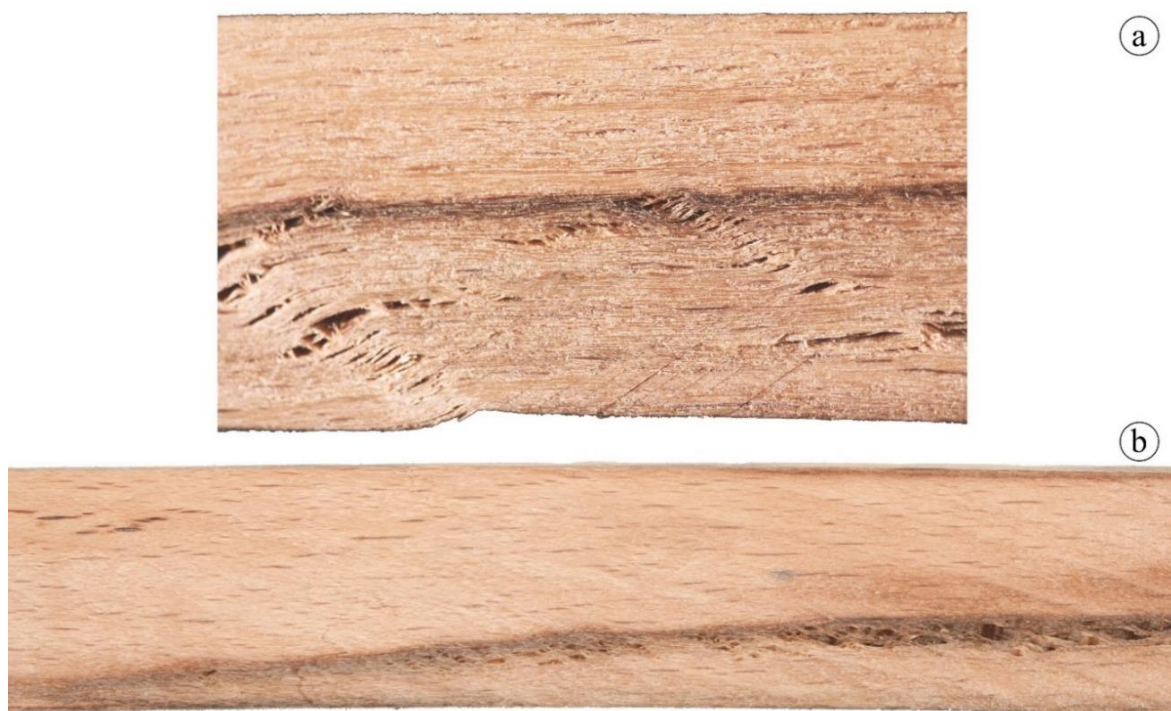
3.11. ábra Megrogyások az álgesztben, míg a felette látható álgesztmentes rész sértetlen (a) és repedések kizárólag az álgeszt erősen elszíneződött részében (b) (Báder és Németh 2017e)
