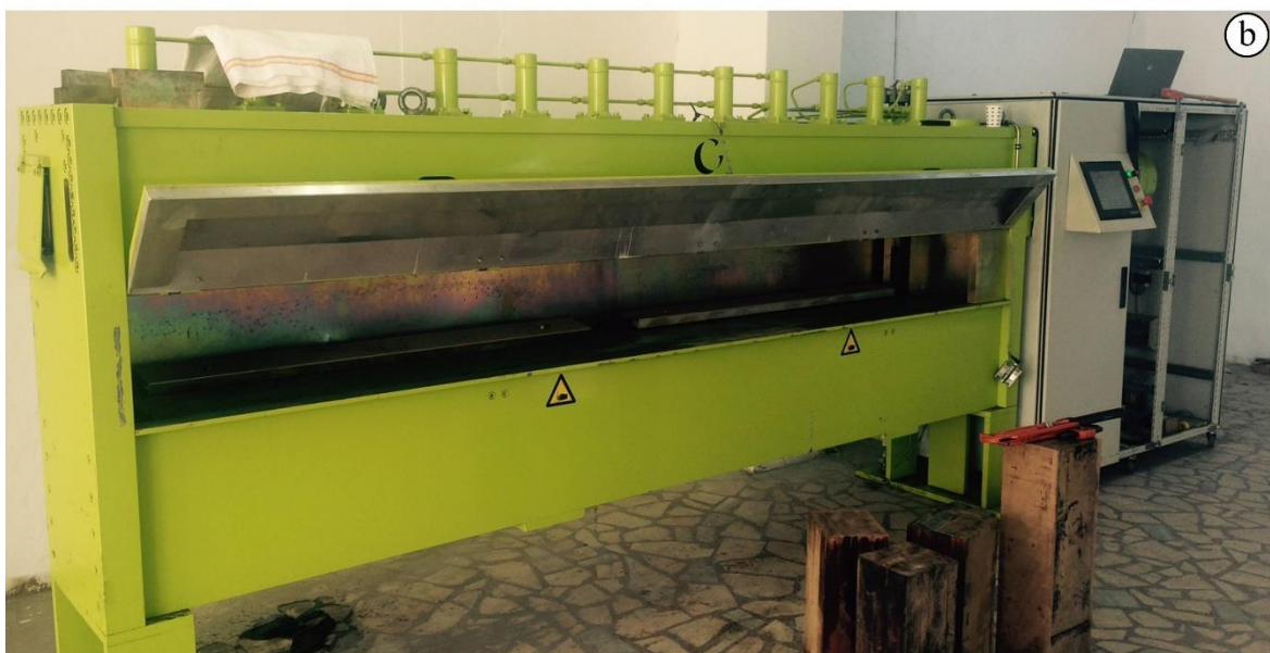
2.7. ábra Tömörítő gép elvi összeállítása (a) és egy gyakorlati megvalósítása (b) (forrás: Thomassen és tsai. 1990 és Compwood 2019a)
