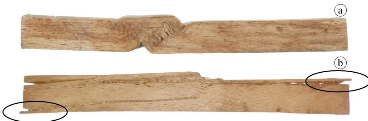
3.1. ábra Hibajelenségek: minta rostsztérválása és megrogyása tömörítés közben az alacsony nedvességtartalom miatt (a) és túlméretes minta széle lelógott az alátámasztásról a bekarikázott részeken és nem került tömörítésre, ami hasadáshoz vezetett (b) (forrás: Báder és Németh 2017e)
