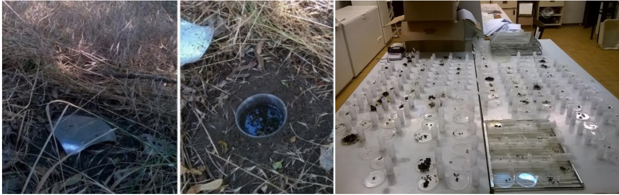
16. ábra: Barber-féle talajcsapda, illetve a szétválogatott minták (Fotó: Németh T. M.)
