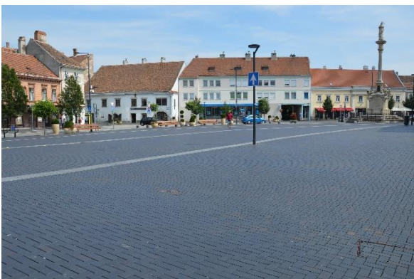
A sötét színű térkővel burkolt nagy felületeken jelentős hőszigetek jöttek létre (Várkerület)
