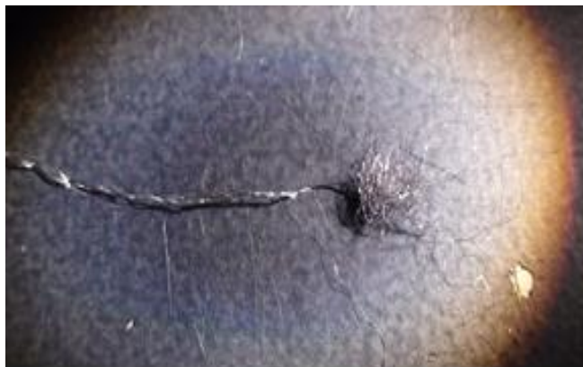
15. ábra Ezüsttel bevont PA filamens 36x nagyításban (ESZ-2 mintakelméből)
