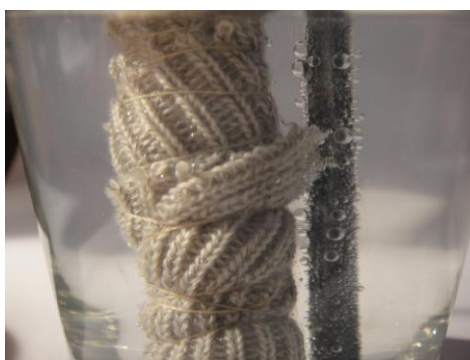
34. ábra Ezüst leválasztása a kelméről elektrolízissel
