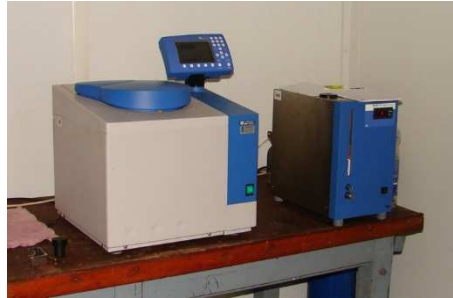
14. ábra: IKA C-2000 típusú automata kaloriméter
