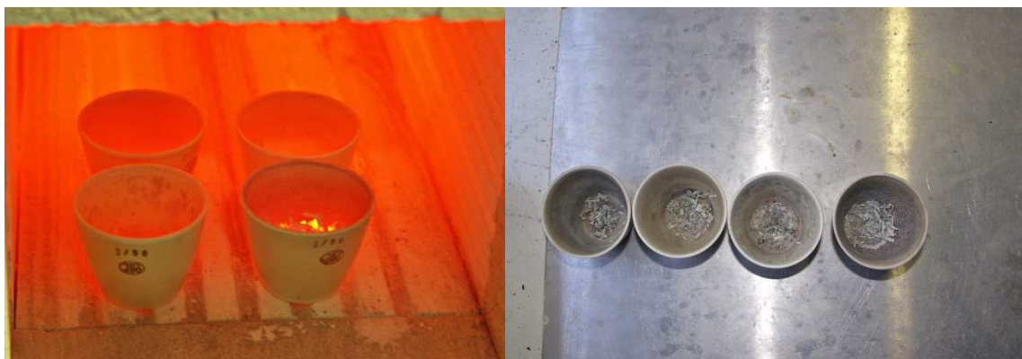
41. ábra: Hamutartalomvizsgálat izzítókemencében
