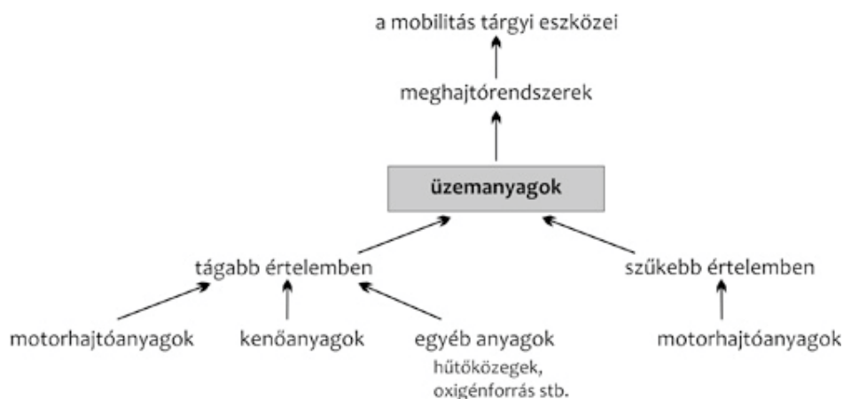
3. ábra: Belsőégésű motorok üzemanyagainak rendszerszemléletű osztályozása [Hancsók, 2012]
