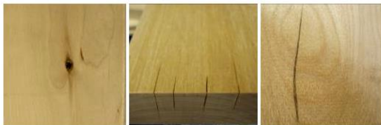
17. ábra: Fahibák típusa (fekete göcs, lap- és bütürepedés, bélholt) (Forrás: saját ábrák)
