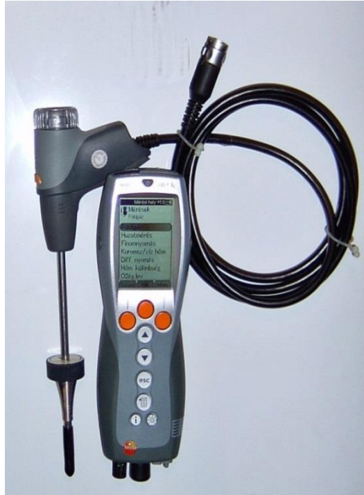
25. ábra: Füstgázelemző berendezés (Testo)
