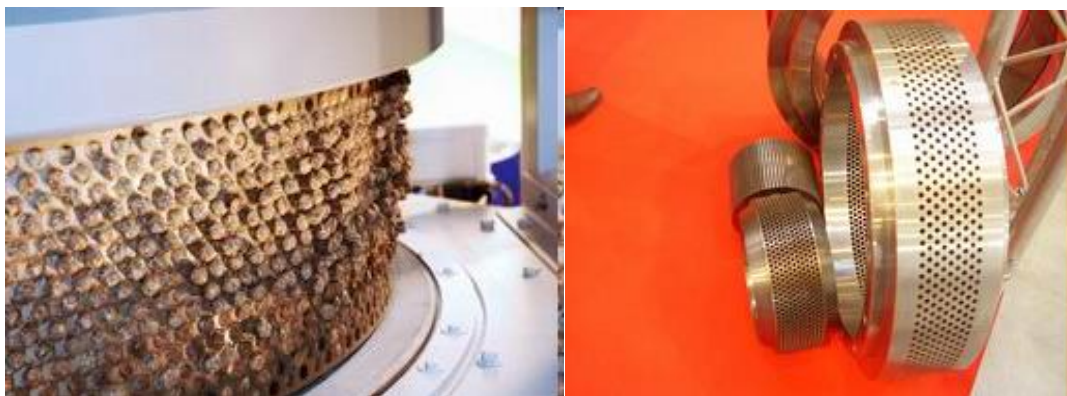
5. ábra: Gyűrűs matricás pelletprések
