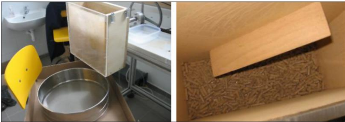
14. ábra Mechanikai ellenálló képesség mérése
