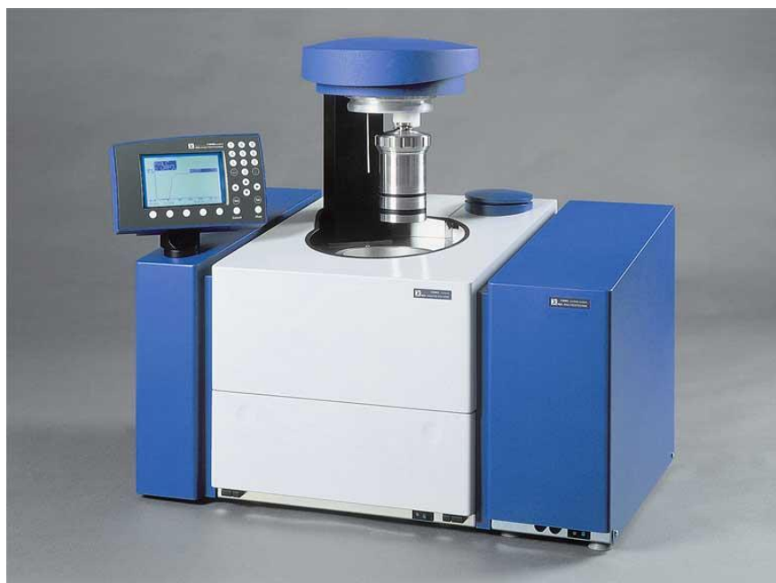
11. ábra: Kaloriméter IKA C-2000
