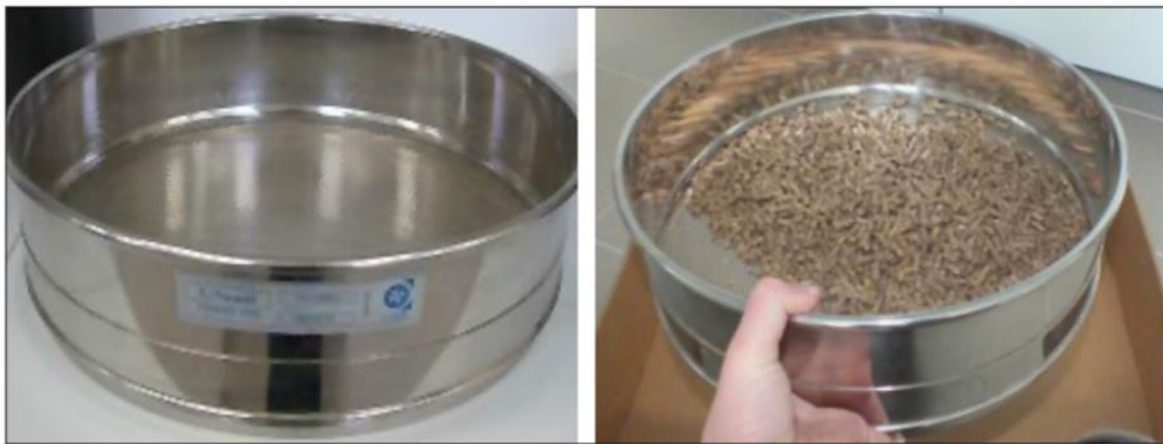
13. ábra: A finomhányad meghatározása, szitálás
