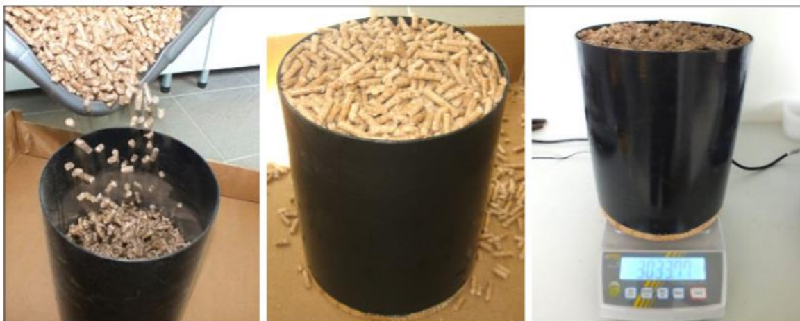
15. ábra Pelletek térfogati sűrűségének mérése
