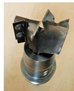
38. ábra MAKА SC 20T típusú CNC vezérlésű felsőmaró és a maráshoz használt szerszám (Saját felvétel)
