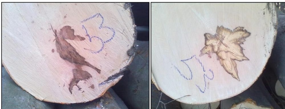
51. ábra: egy erdészeti rakodón található 3 m hosszú törzsszakasz alsó és felső vágáslapi álgesztformája
