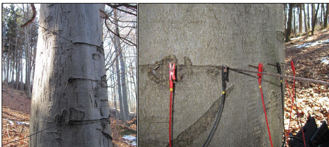
48. ábra: idegen testet benőtt 167/G bükk egyed és vizsgálata
