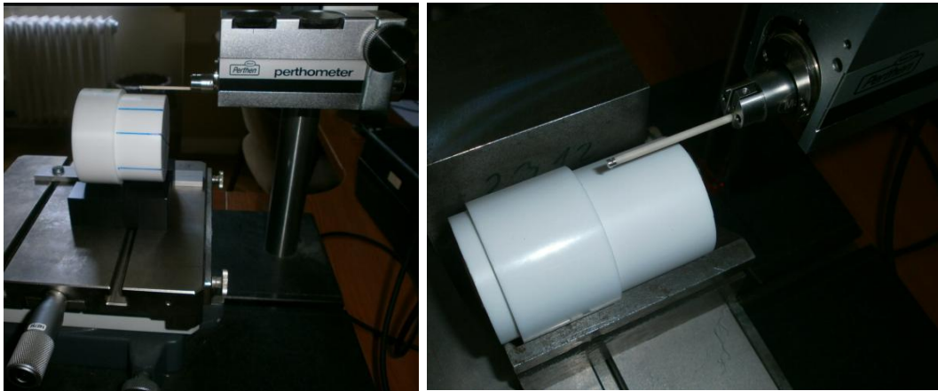
III.7. ábra. A felületi érdesség mérése
