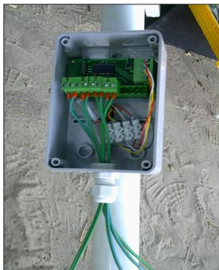
13. kép: A meteorológiai állomás EcoLogger Boreas adatgyűjtője.
