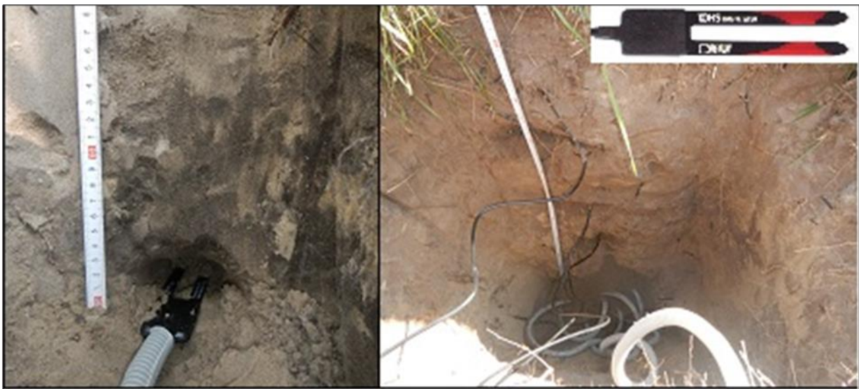
18. kép: A Decagon 10 HS szonda telepítése Bócsa 51 TII részletben.
