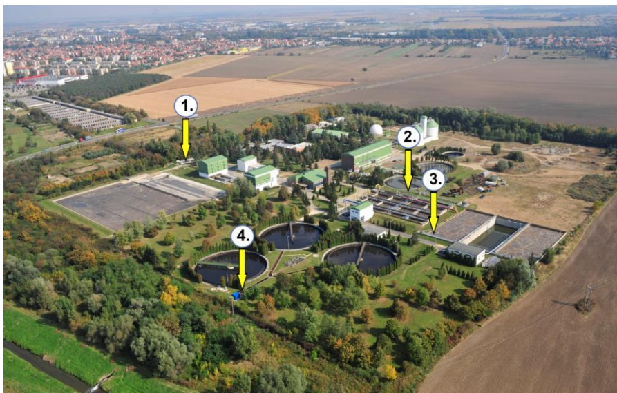
3. ábra: A szombathelyi regionális szennyvíztisztító telepen kijelölt mintavételi pontok
