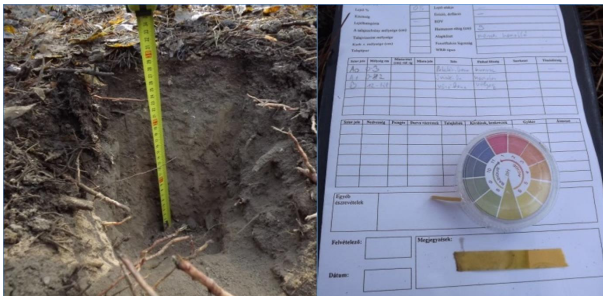
10. ábra: Helyszíni talajvizsgálat (Dudlesz- eredeifenyő állomány)
