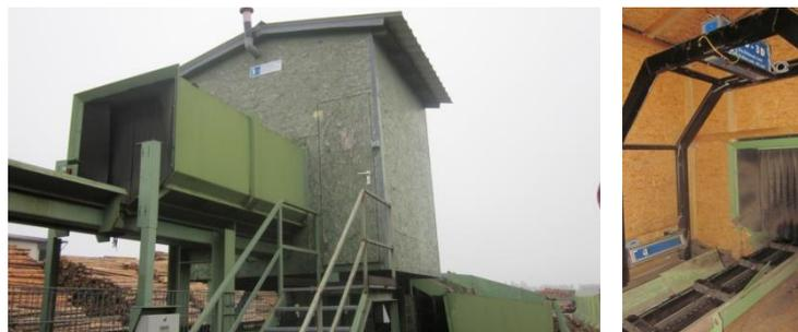
Abbildung 8: Vermessungsstation mit Laser-Kameraeinheiten des Typs JORO-3D
