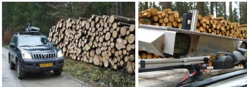
Abbildung 2: Kamerasystem der Fa. Dralle (MÜLLER, 2008)
