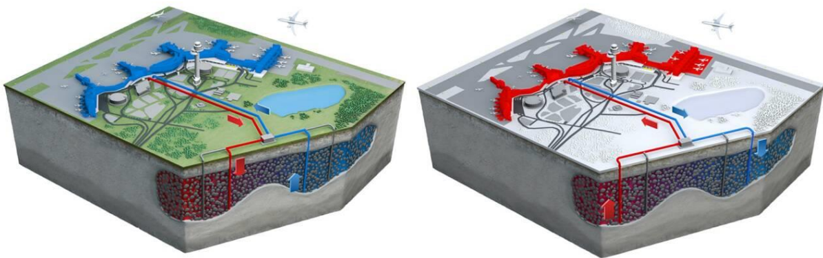
2. ábra. ATES működési elve nyári (balra) és téli (jobbra) időszakban. (Underground Energy é. n.)
