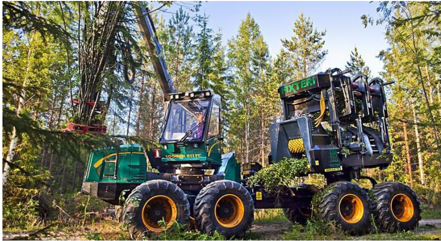
22. melléklet: Logmann – Fixteri döntő–kötegelő gép (Forrás: Lappalainen, 2011)
