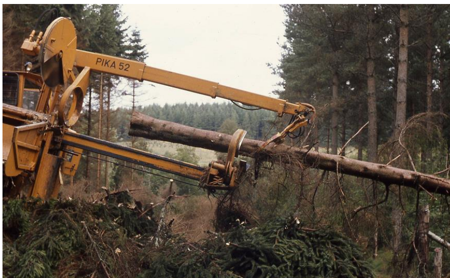
31. melléklet: Valmet 880S/Pika 52 (1972) gallyazó–daraboló–előközelítő–rakásoló gép (Forrás: www.forestry-memories.org.uk )
