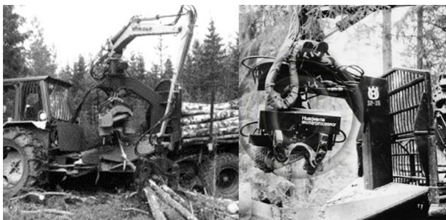
32. melléklet: Husqvarna Skotarprocessor SP 26 – Rottne (1977) gallyazó–daraboló–közelítő gép (Forrás: www.skogenbild.com ; www.finna.fi )
