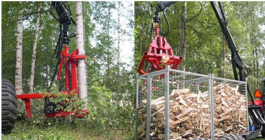
23. melléklet: Nokka Brennholzharvester döntő–gallyazó–hasító–daraboló gép (Forrás: www.nokka.fi )
