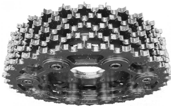
69. melléklet: TP-Roller, nyitott menesztő henger (Forrás: www.ammattilehti.fi )
