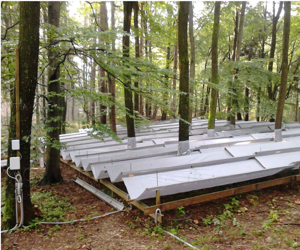
15. ábra. Moduláris takarórendszer a szárazság szimulálásához.
