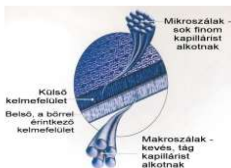
2.14 ábra: Makro és mikro szálak kombinációja nedvességelvezetés céljából (Lázár 2010)
