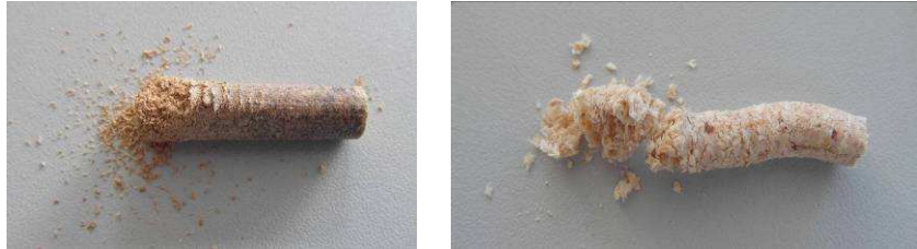
32. ábra. A relatív falsúrlódás miatti sűrűségkülönbség tölgy és fenyő mintán
