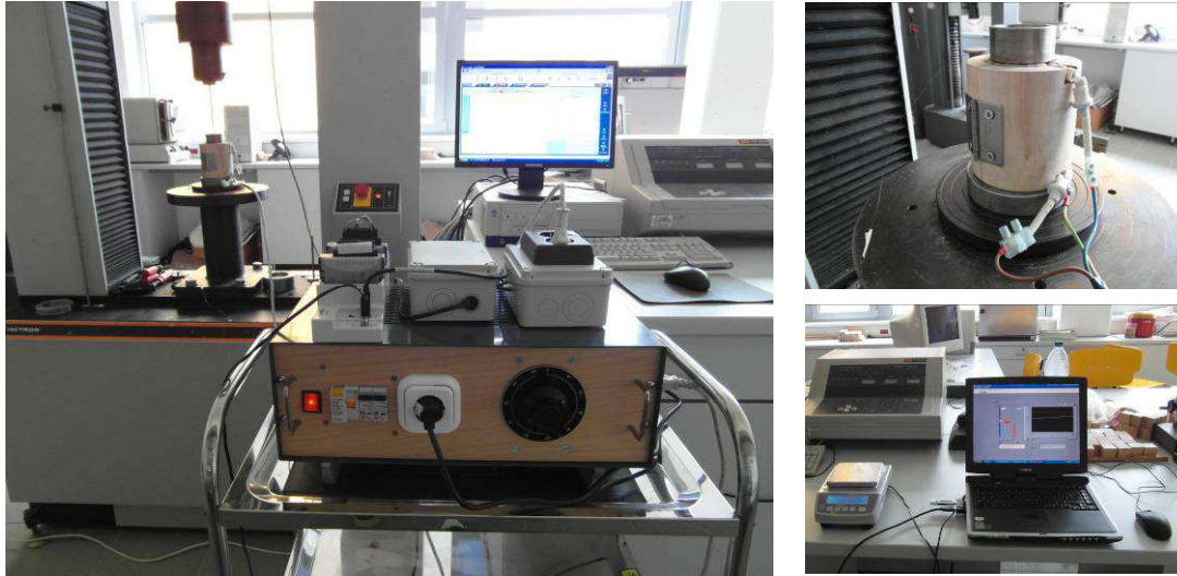
49. ábra. Az egyedi tervezésű és kivitelezésű hőmérséklet szabályozó és mérőkör működés közben
