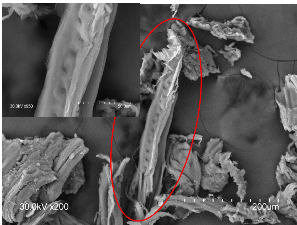
119. ábra. Fenyő tracheida udvaros gödörkés sejtalfalvastagodással (A felvétel készítésének időpontja: 2014. július 24.)
