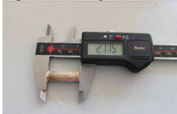
56. ábra. Pellet hosszamérés digitális tolómérővel (felbontása: 0,01mm; pontossága: \pm 0,02\% )
