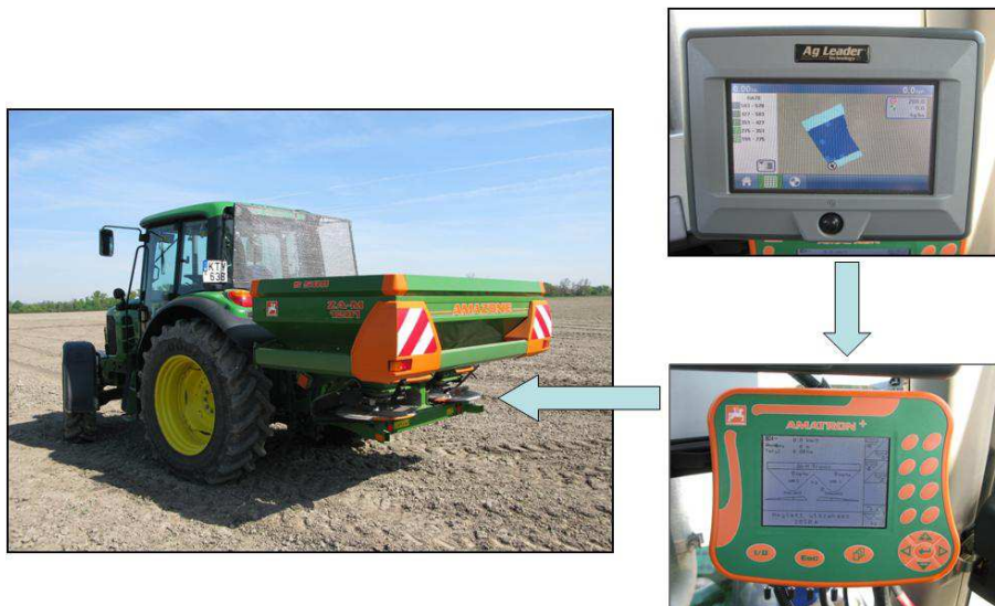
9. ábra: A helyspecifikus kijuttatás-vezérlő rendszer felépítése
