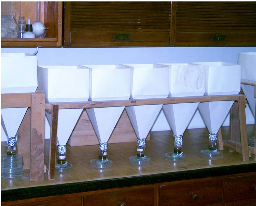
5. ábra Talajminták futtatása a Balogh- Loksa-féle papírtölcséres futtatóval
