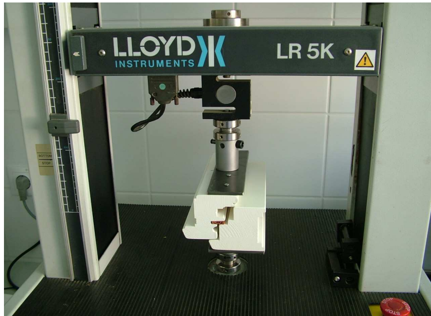
58. ábra A kúszás vizsgálata a LLOYD –LR 5K univerzális szakítógépen
