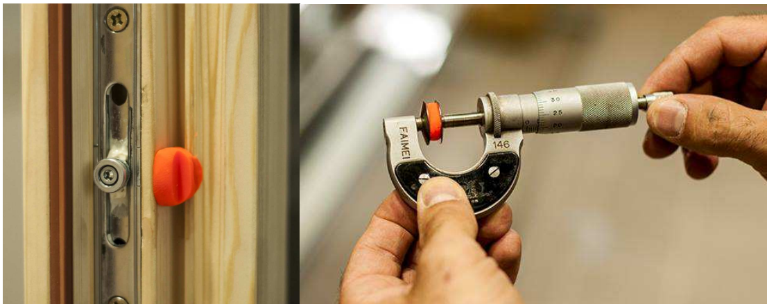
35. ábra. A tok és szárny távolságának meghatározása
