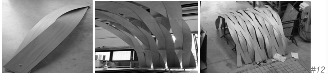
#12: Lausanne, IBOIS fonott rétegelt lemezek. [SisM2013]
