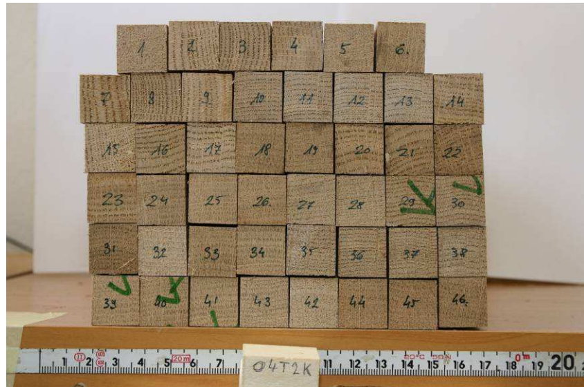
17. ábra – Nagy felbontású fotó a próbatestek bütüjéről (04T2K-jelű köteg) (fotó: Szeles Péter)
