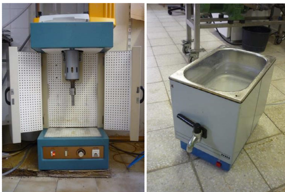
36.ábra Az anyagelőkészítéshez felhasznált ultrahangos berendezések, rudas ultrahangos berendezés (balra), ultrahangos kád (jobbra)
