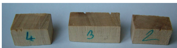
17.ábra SEM-os elemzéshez előkészített 'I-214' nyár minták
