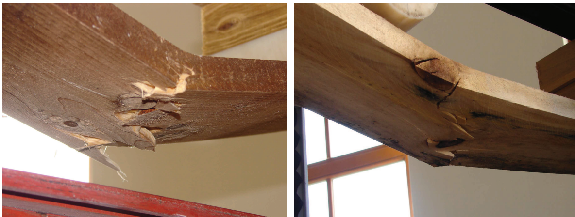
43.ábra 4 pontos hajlítószilárdsági tönkremenetel erdeifenyő (bal) és 'Pannonia' nyár (jobb) esetén
