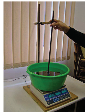
22.ábra A törzsmetszetek (korongok) térfogatának meghatározása
