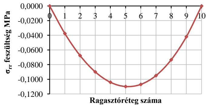
104. ábra A \sigma_{rr} külső terhelésből származó feszültségek a ragasztási rétegekben a 7. keresztmetszetben
