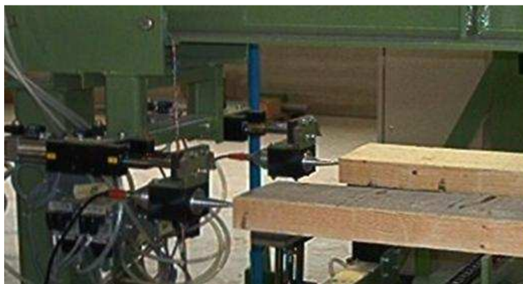
3.3 ábra: Triomatic ultrahangos osztályozó berendezése működés közben
