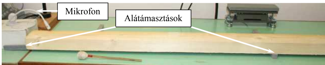
4.28 ábra: Torziós rezgések mérésének elrendezése
