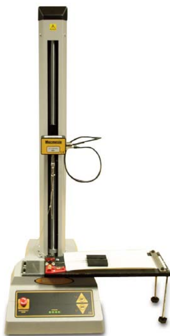
m1.85. ábra. Mecmesin Coefficient of Friction Testers súrlódásmérő készülék (Mecmesin, 2011)
