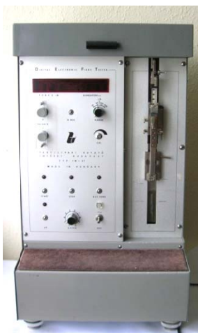
51. ábra Fm-27 típusú elektronikus elemiszál szakító gép
