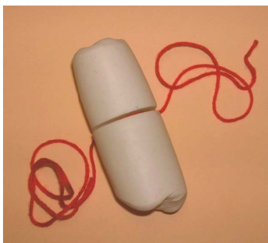
34. ábra A képlékeny hengerbe bevágódott hímzőcérna
