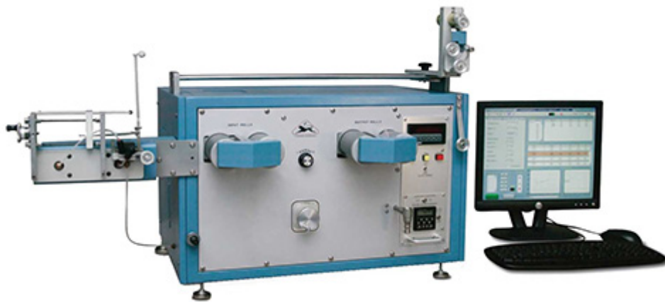
m1.88. ábra. LH-402 CCT súrlódásmérő készülék (Lawson – Hemphill, 2011)
