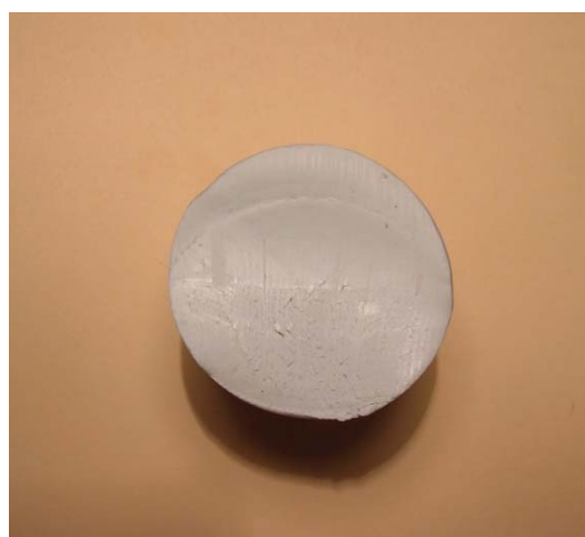
35. ábra A bemélyedés mentén szétválasztott képlékeny henger
