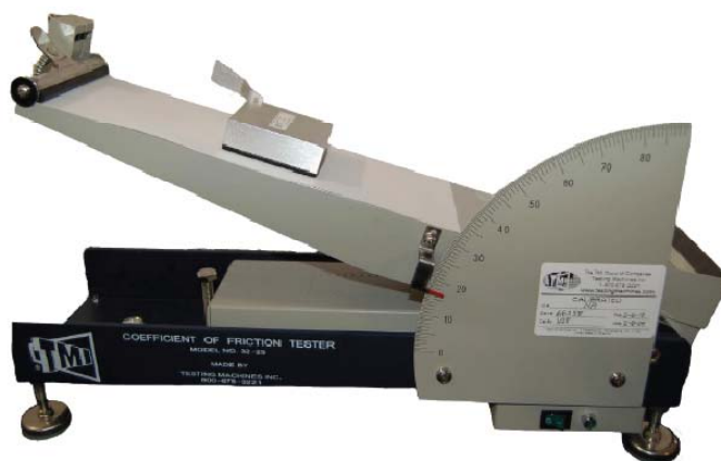
m1.79. ábra. 32-25-00 súrlódásmérő készülék (Testing Machines Inc., 2011)
