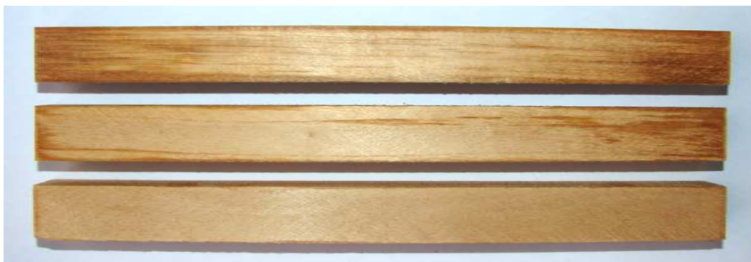
13. ábra A felvett olaj eltérő keresztmetszeti eloszlása és az eltérő olajfelvétel szemléltetése a faanyagban, azonos menetrend esetén (160°C/6 óra)
