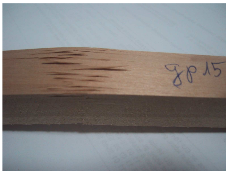
11. ábra: Szálkás törés (FOTÓ: KATONA)
