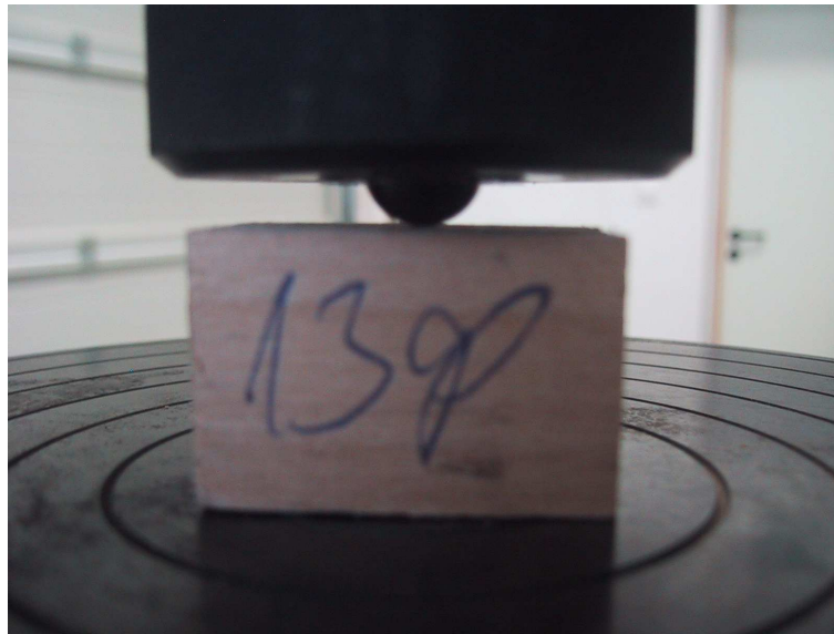
14. ábra: Brinell-Mörath-féle keménység vizsgálat (FOTÓ: KATONA)
