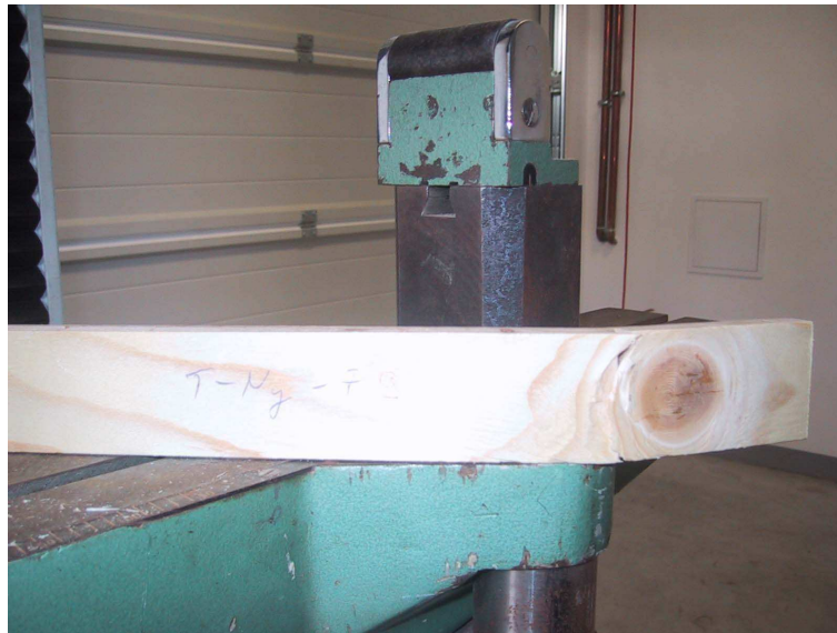
19. ábra: Alsóréteg göcsössége 2. (FOTÓ: KATONA)
