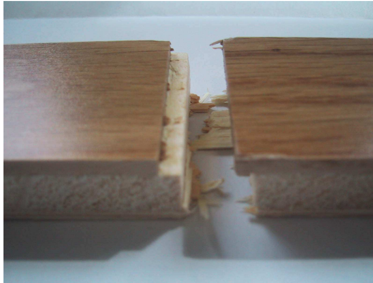
16. ábra: Járóréteg-hossztoldás és középréteg-rés közelsége (FOTÓ: KATONA)
