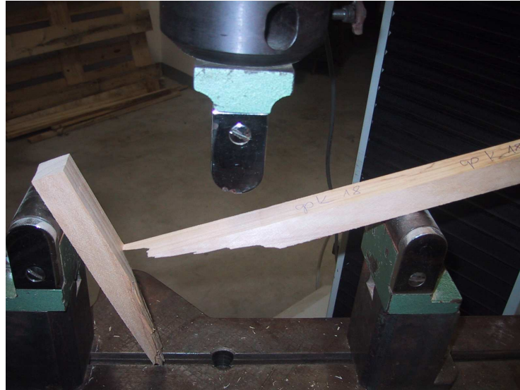
12. ábra: Harántrost törés (FOTÓ: KATONA)
