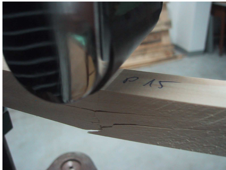
10. ábra: Húzott öv egyszerű törése (FOTÓ: KATONA)
