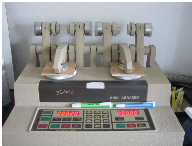
23. ábra: Taber-féle kopásállóság vizsgálógép (FOTÓ: KOROKNAI)
