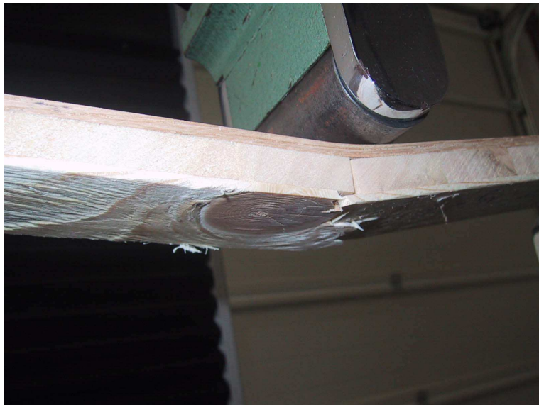
18. ábra: Alsóréteg göcsössége 1. (FOTÓ: KATONA)
