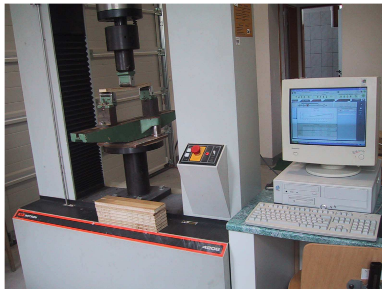
15. ábra: INSTRON 4208 univerzális anyagvizsgáló berendezéssel (FOTÓ: KATONA)
