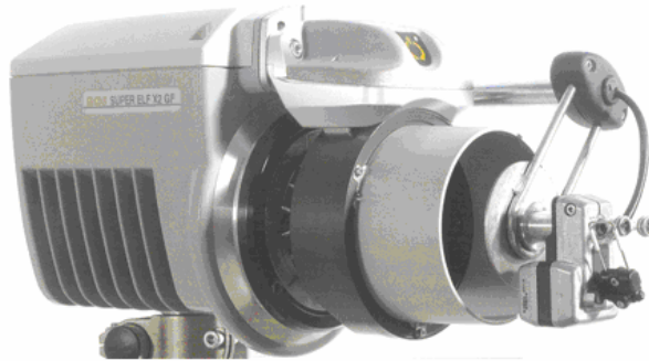
3.7. ábra. Korszerű ROJ SUPER ELF X2 GF hossz mérős vetülettároló[12]
