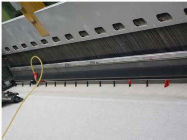
7.6. ábra. Segédfűvókák helytelen üzemállapotának modellezése
