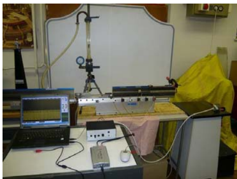
6.1. ábra. A laboratóriumi mérőpad a profilborda tengelyében kialakuló áramlási sebesség mérésére
