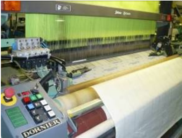
3.31. ábra. Vetülékbevetési hiba miatt leállt légsugaras szövőgép
