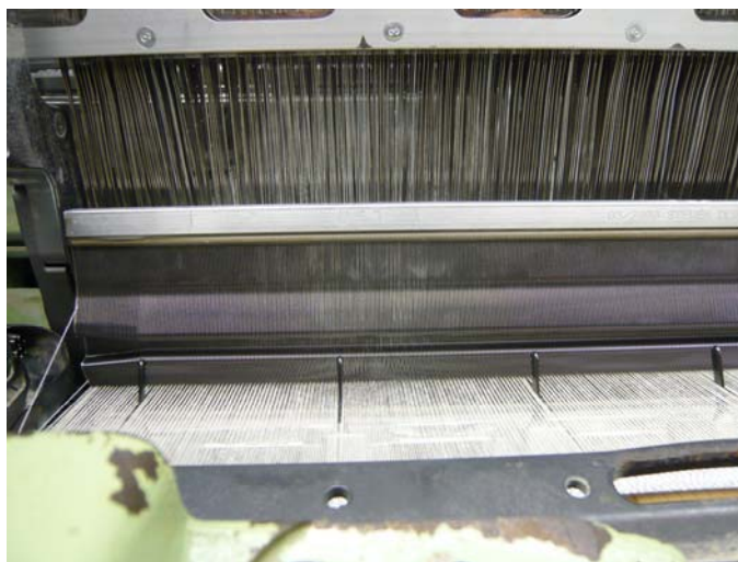
7.5. ábra. Segédfűvókák elhelyezése a borda mentén
