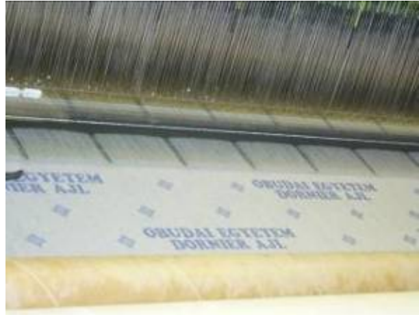
3.31. ábra. Vetülékbevetési hiba miatt leállt légsugaras szövőgép
