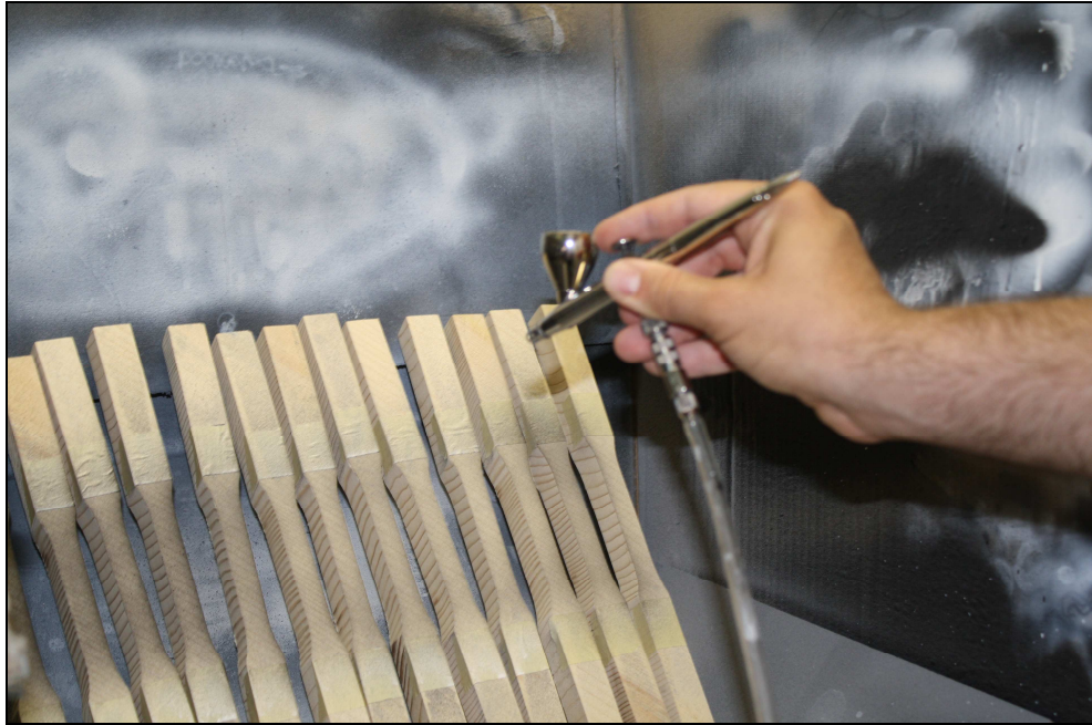
50. ábra: Próbatess előkészítése a DIC-2D rendszer alkalmazásához
