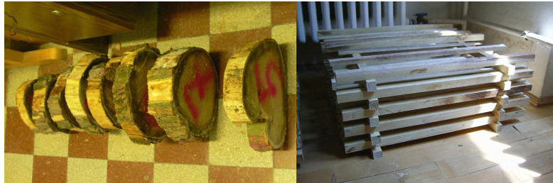
3.14 kép A korong és rúd próbatestek
