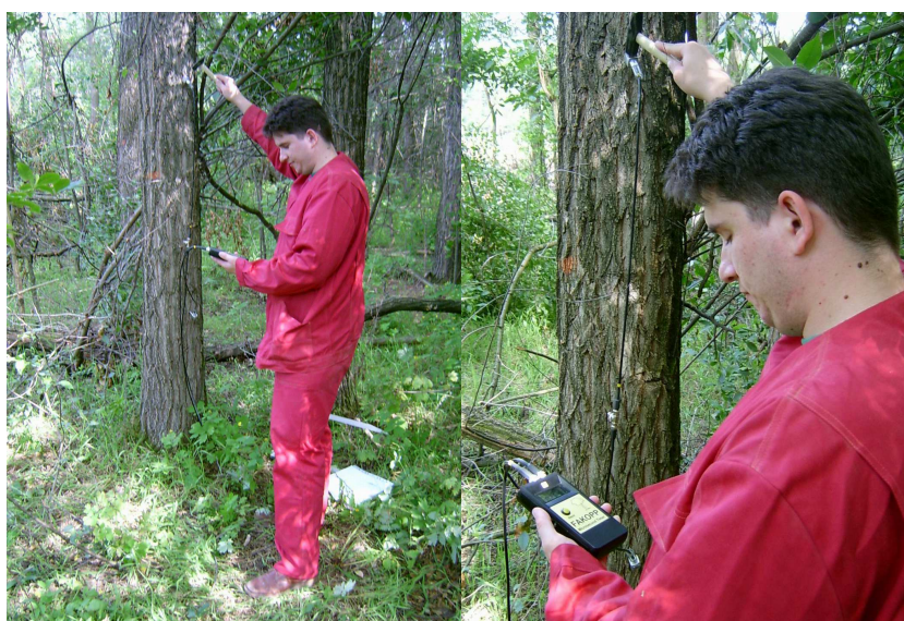
3.1 kép Rostirányú hangsebességmérés a kiválasztás helyszínén (Kaszói erdőgazdaság)
