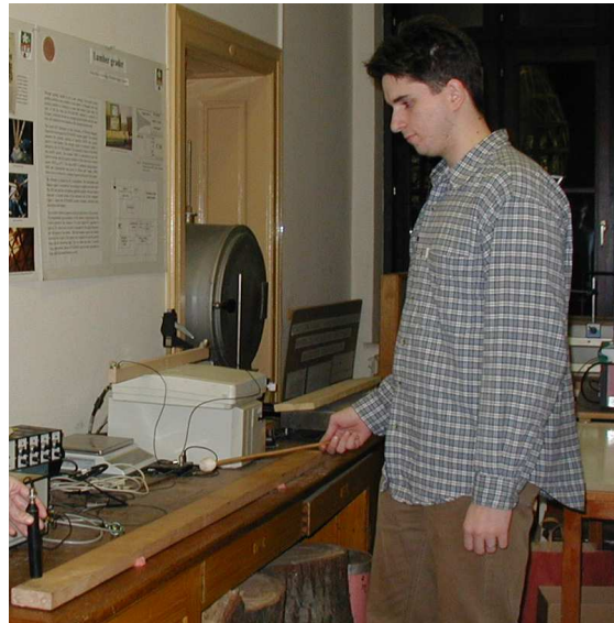
3.20 kép Hajlítórengések frekvenciájának mérése
