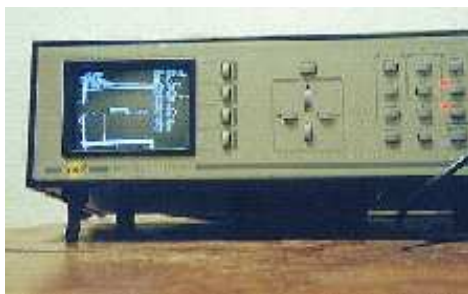
3.15 kép FFT analízátor készülék
