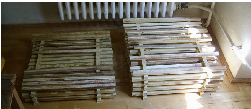
3.18 kép Természetes szárítás máglyában
