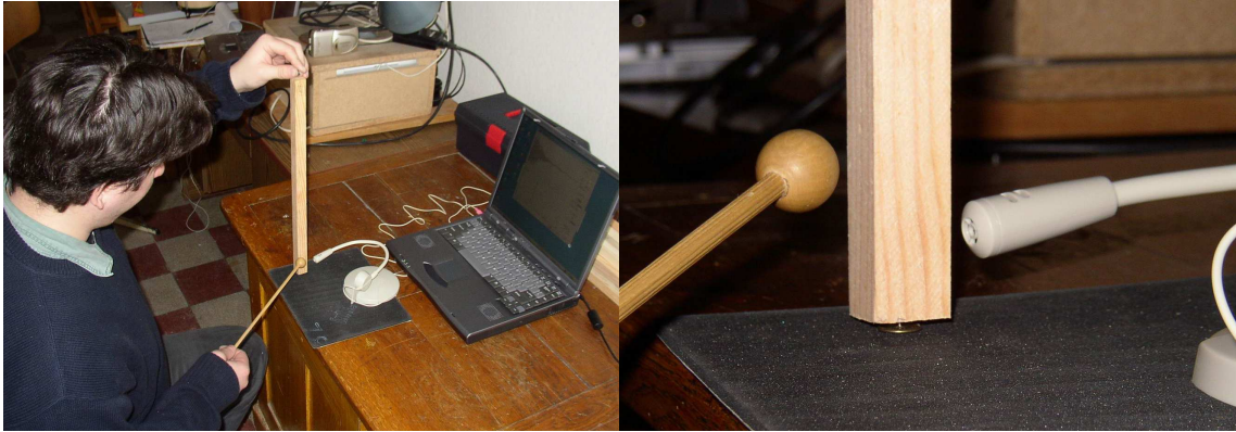
3.23 kép Torziós rezgésekkel meghatározott G mérési elrendezése
