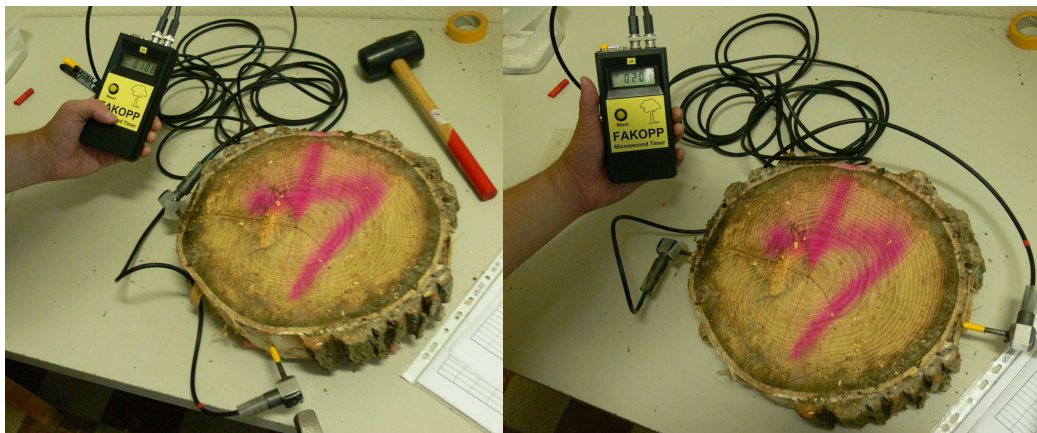
3.24 kép Tangenciális sebességmérés
