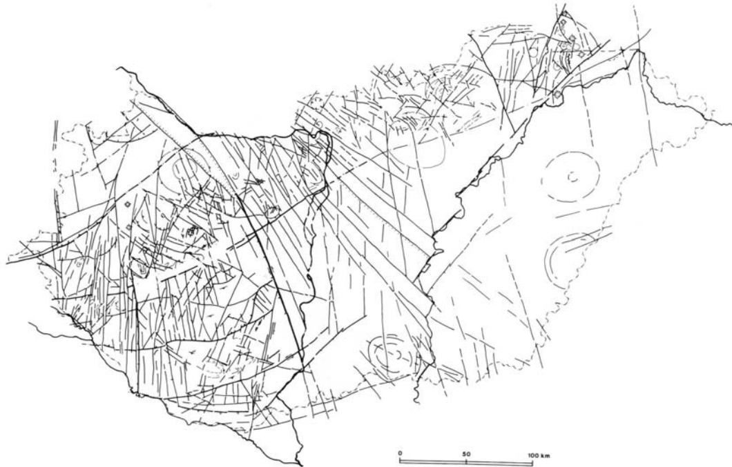
9. ábra. Magyarország lineamentum térképe Landsat MSS képek vizuális kiértékelésével (BREZSNYÁNSZKY & SÍKHEGYI 1987)
