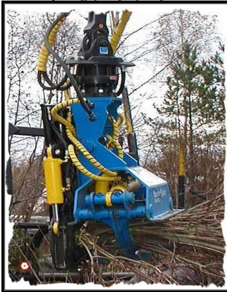
42. ábra: Naarva Grip 1500 gyűjtő-vágó fej energetikai faültetvényekhez I.
