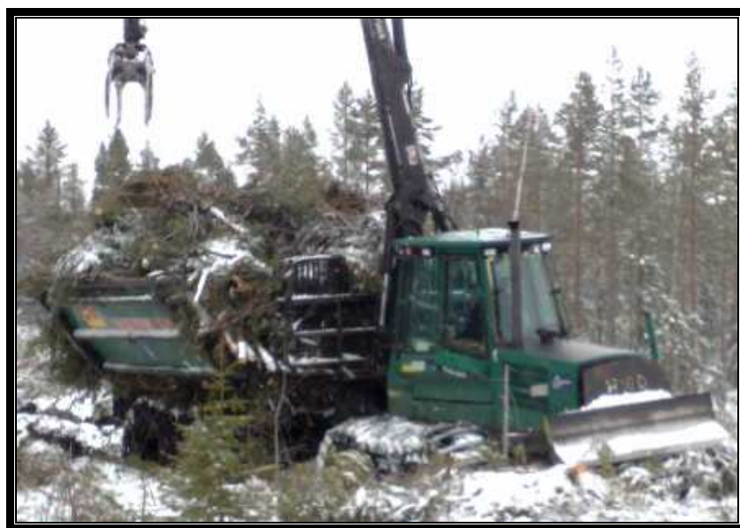
34. ábra: Timberjack gyűjtő-kihordó II.
