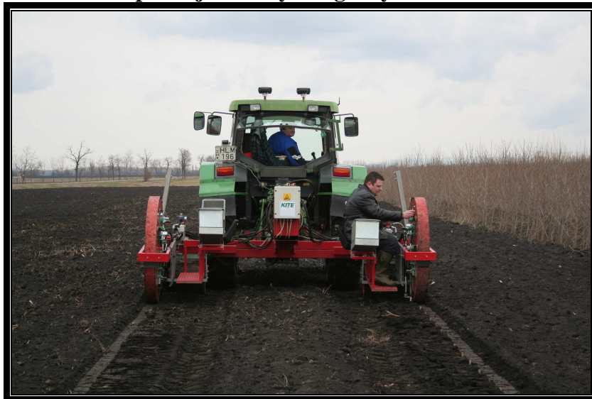
6. ábra: Közepes teljesítményű dugványültető munka közben
