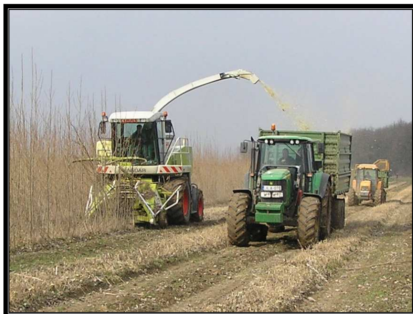
49. ábra: Claas Jaguar járvaaprító, aprítékgyűjtés kiszolgálással
