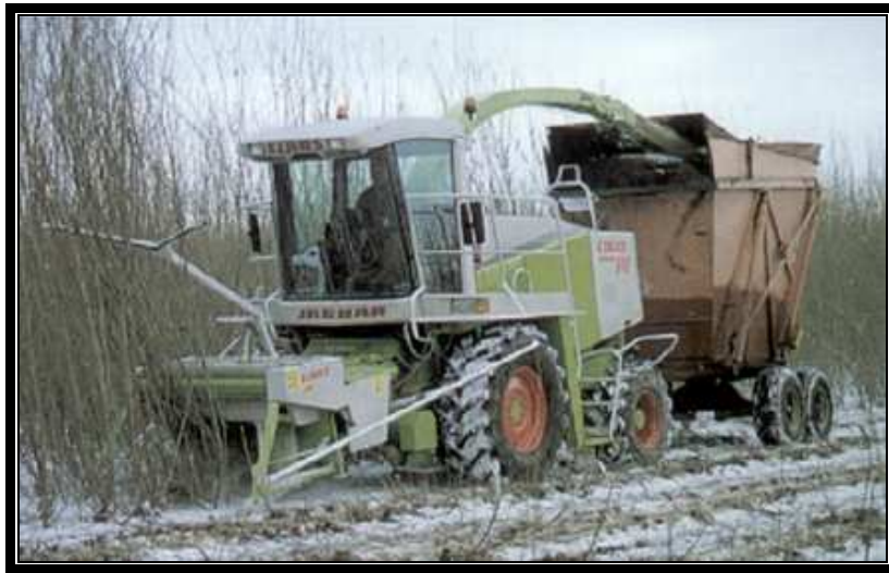
50. ábra: Claas Jaguar járvaaprító kapcsolódó tartállyal
