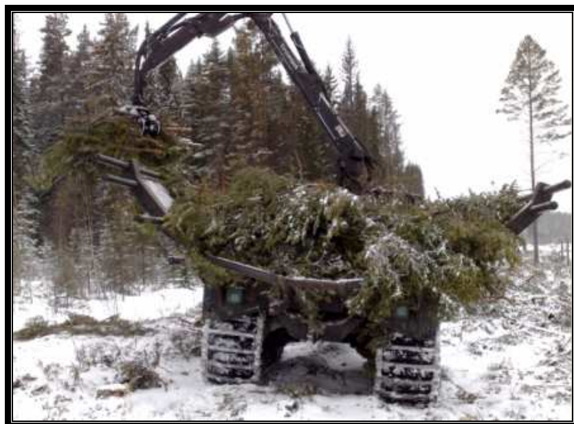
33. ábra: Timberjack gyűjtő-kihordó I.
