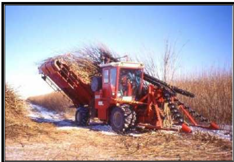
37. ábra: Sagerslätt Empire 2000 rendvágó-gyűjtő-kiszállító gép
