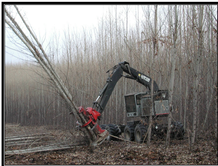
40. ábra: Kihordó nagyteljesítményű gyűjtő-vágó fejjel
