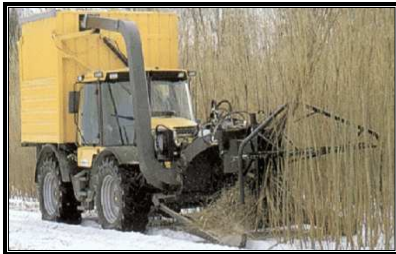
51. ábra: Saját konténeres járvaaprító
