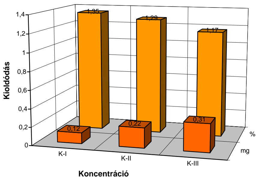
12. ábra. Erdeifenyő próbatestekből kioldott összes króm mennyisége és százalékos aránya a bevitthez képest a különböző védőszerfelvételek ( K-I - -K-III ) esetében
