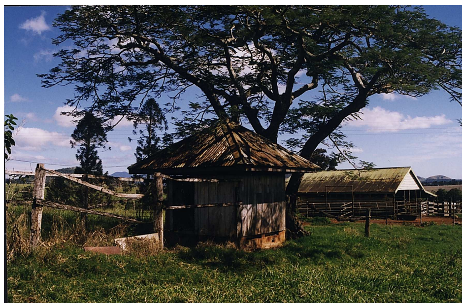
60. ábra 'Separator shed' egy queenslandi farmon: a tejfarmokon ilyen épületekben végezték a tej fölözését. A tej megromlásának elkerülésére ezek mindig jól árnyékolt és átszellőző építmények voltak, amiért Hall előszeretettel alkalmazza geometriájukat természetes szellőzésű épületeihez, például a Judge ház esetén is.
