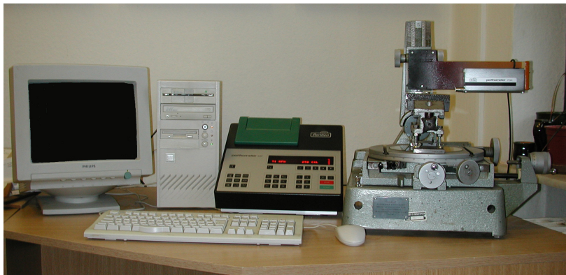
37.ábra: Az érdességmérő műszer és tartozékai
