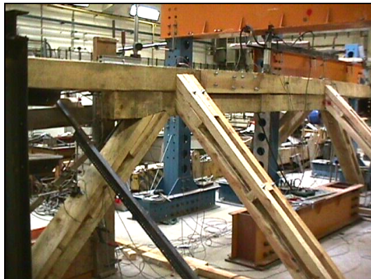
Œ j. tartó: térben is kitámasztott kettős feszítőmű
